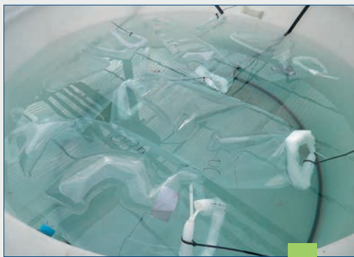
Abb. 3. Kleinskalige Experimente (50 l Beutel, gefüllt mit der natürlichen Planktongemeinschaft der Bucht Melenara, Gran Canaria). / Fig. 3. Small scale experiments (50 l plastic bags filled with a natural plankton community of Melenara Bay, Gran Canaria). (Foto / Source IOW).
