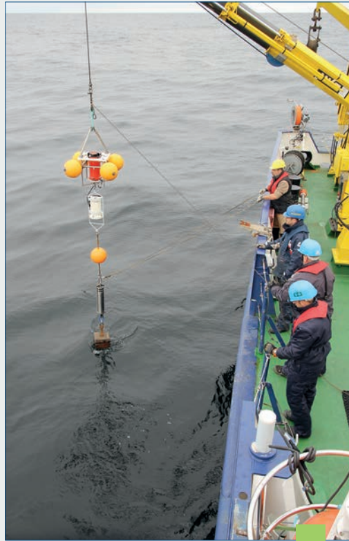
Ausbringen eines verankerten Strömungsmessers im Rahmen des DFG-Projekts RedoxIntrusions während der FS ELISABETH-MANN-BORGESE-Reise im Oktober 2014. / Deployment of a moored flow meter in the frame of the DFG project RedoxIntrusions during the expedition of RV ELISABETH-MANN-BORGESE in October 2014. (Foto / Source: IOW)
