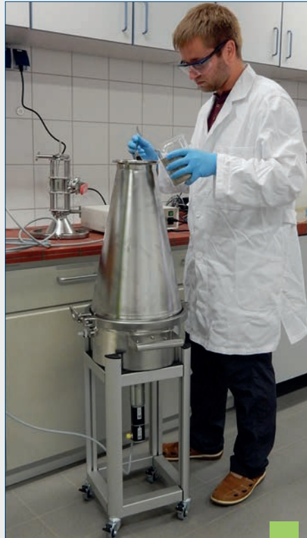
Alexander Hentzsch beim Bearbeiten einer Sedimentprobe in einem Mikroplastik Sediment Separator. / Alexander Hentzsch processing a sediment sample in a MicroPlastic Sediment Separator. (Foto / Source: IOW)
