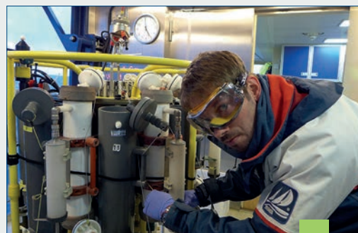
Christian Meeske entnimmt mikrobiologische Wasserproben mit dem AFIS CTD-System. / Christian Meeske collecting microbiological water samples with the AFIS CTD-System. (Foto / Source: IOW)
